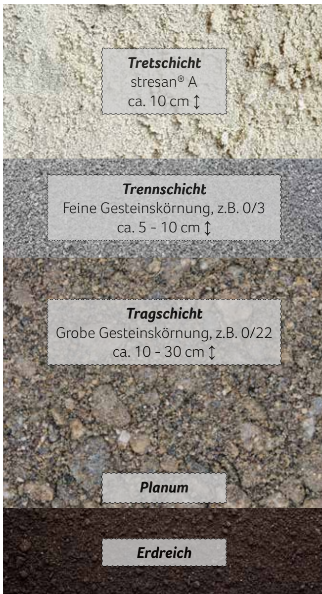
Tretschicht aus purem Sand mit Trennschicht
