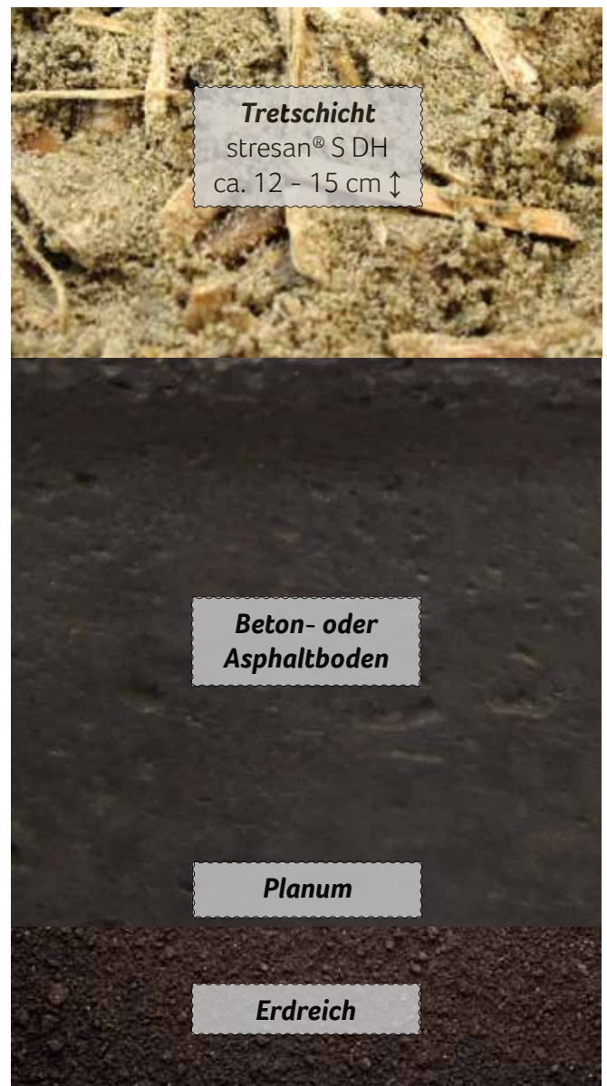
Tretschicht mit Siebgut auf Betonaufbau
